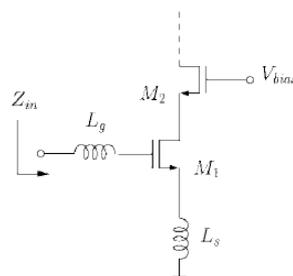
Fig. 3. a cascode L-degen LNA
