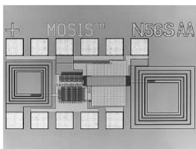
Fig. 2. layout of a 1.5GHz LNA
